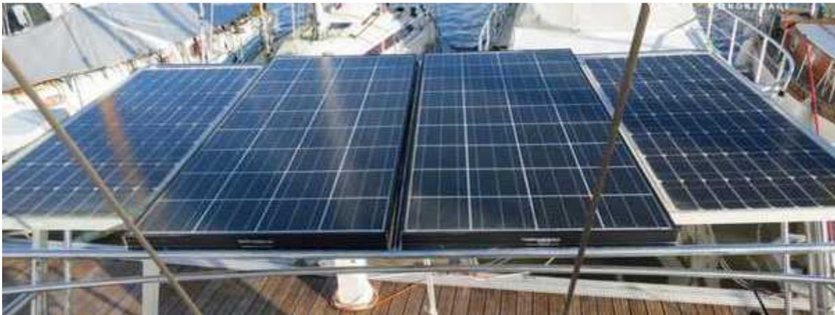
Les panneaux solaires n'ont pas de pièces mobiles, sont durables, et à bien des égards sont mieux adaptés à un mode de vie vagabond au soleil que les éoliennes.
